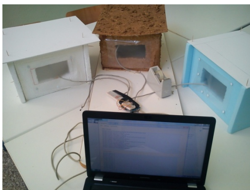
Σχήμα 9 : Η διάταξη μέτρησης θερμοκρασιών των σπιτιών
